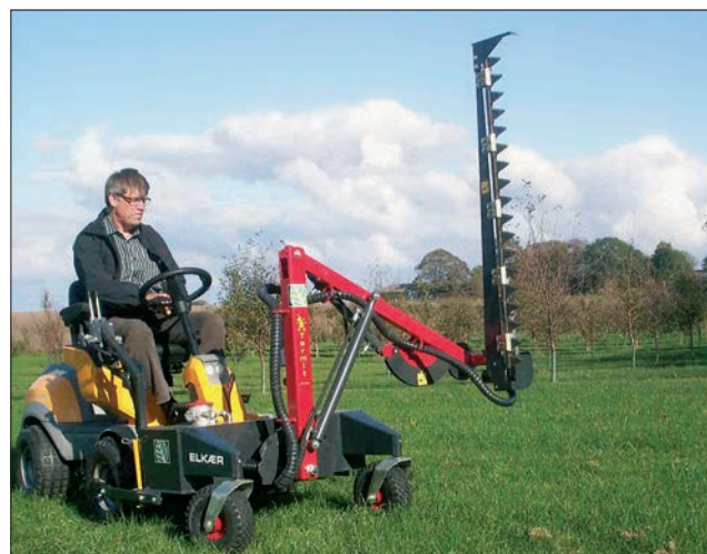
Die Astschere Termit ist für die Rasentraktoren ausgelegt.
