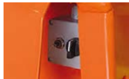
Zweite Schaltstelle an der Seilwinde
