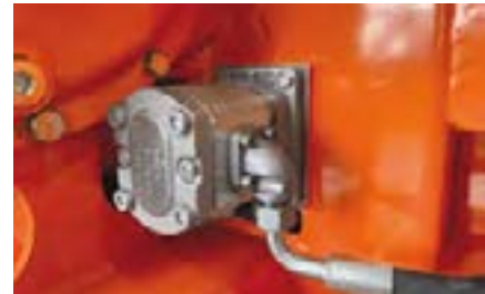
Eigenversorgung mit BOSCH-Hydraulikpumpe
