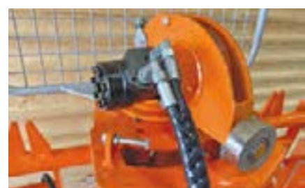
Wickelturm mit Schwenkkopf für perfekte Wicklung und Seilverteilung Seilausstoß mit integrierter Seileinlaufbremse
