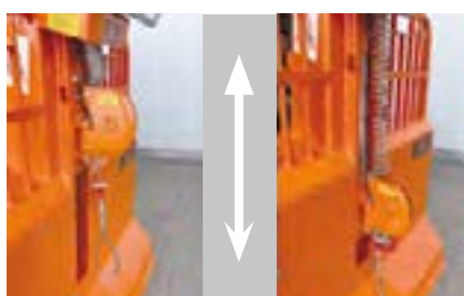
Die von der Traktorhydraulik durch eigene Ölversorgung unabhängige hydraulische Seileinzugshöhenverstellung kann per Hand oder über Funk bis zu 65 cm verstellt werden.
